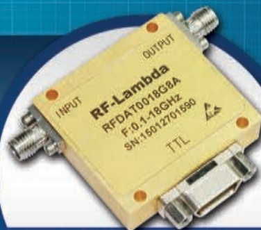
PN: RFDAT0018G8A DIGITAL STEP ATTENUATOR 0.1-18GHz 8 BITS 128DB IP3 50DBM
